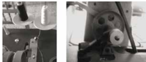
Figura 2. Carrete del hilo de la aguja (negro) y carrete para el devanador del hilo inferior (blanco).
